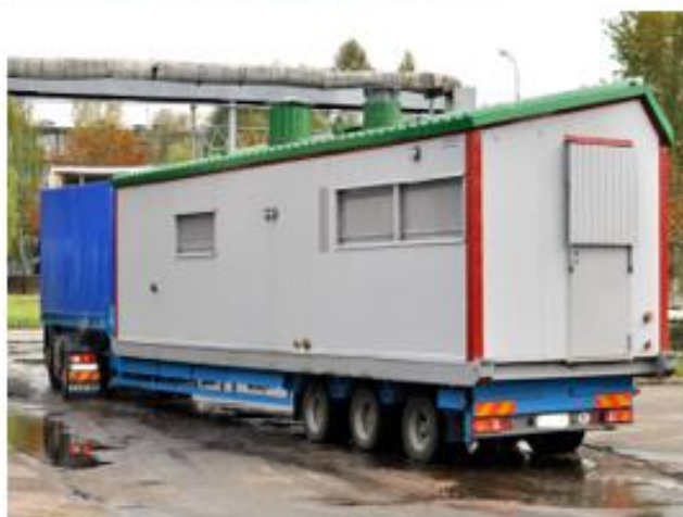
Рисунок 5.1 – Внешний вид передвижных котельных установок
