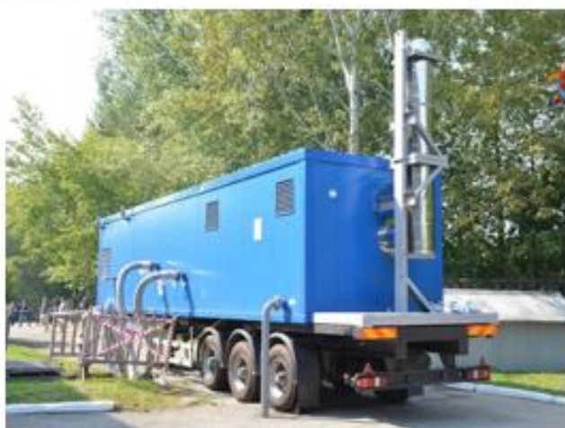
Рисунок 5.1 – Внешний вид передвижных котельных установок
